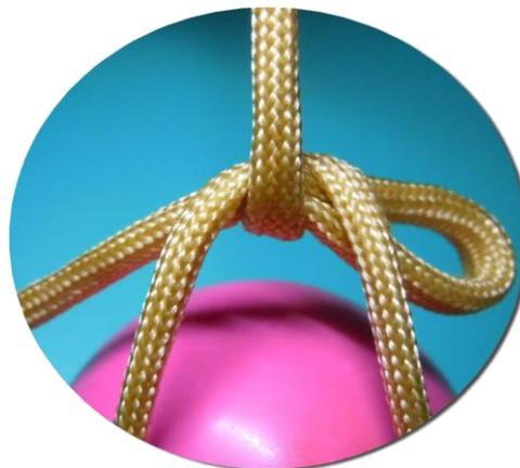
ものを吊るしている下側の 2 本が鋭角になり、元のロープがしっかりとその根元を押さえるようにすると、重量に耐えられる結びになります。2 本の角度が広がり、元のロープがその根元を十分にまとめていないと、この結びはすぐに外れてしまいました。実際に使用では結びが重量に耐えられることをしっかり確認してから作業を行います。
